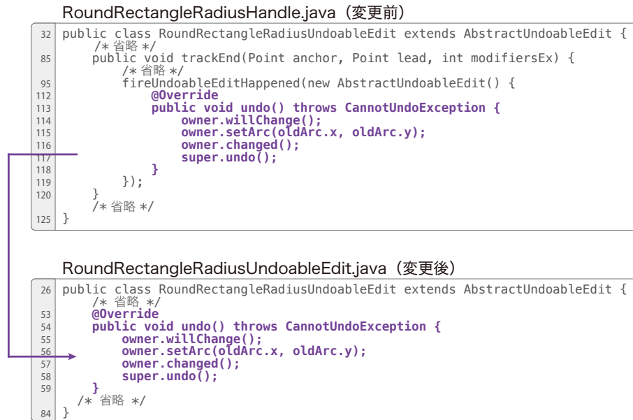
図 10 匿名クラス内のメソッド undo() が通常クラス内に移動する例
