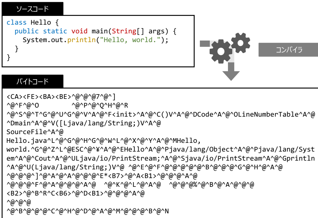
図2 ソースコードをコンパイルして得られるバイトコードの例
