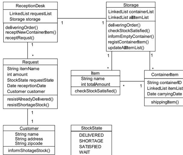
図 5 在庫管理システムの UML クラス図
